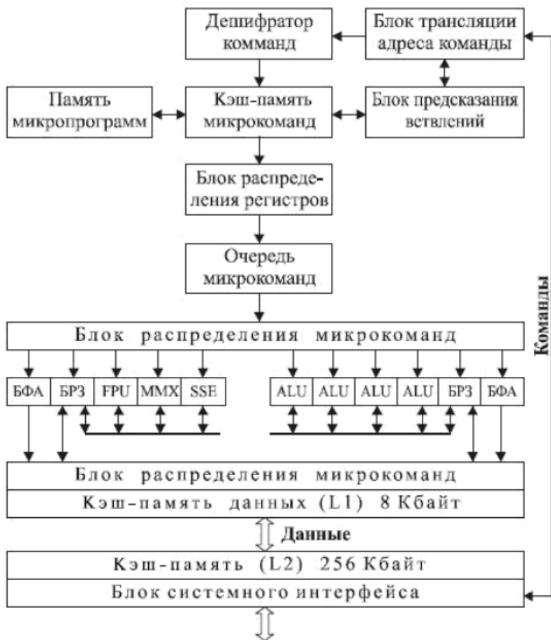
Структура микропроцессора Pentium 4
